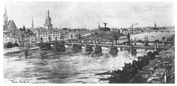
Lithographiertes Projekt für zwei Rheinbrücken, 1897–1898 von Friedrich Keck. Keck wollte die Drahtzugstrasse bis zum Rhein verlängern und über eine zweite Brücke mit dem Fischmarkt verbinden, die teilweise noch hölzerne Mittlere Brücke durch eine Stein-Eisen-Konstruktion ersetzen und darauf rittlings eine Volkshalle mit zentralem Musikpavillon setzen. Wir geben ein Exemplar des Staatsarchivs wieder (Plan G 3, 96)
