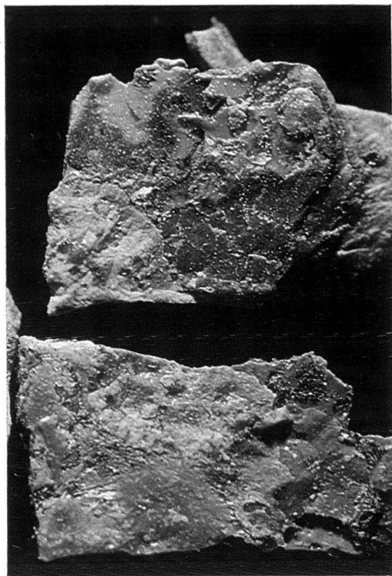
Abb. 3. Farbsplitter von der Weltkugel, Maßstab 19:1, Rückseite. Mehrere Schichten mit Smalte (blaue Splitter) sowie mit Gold auf olivgelber Grundierung
