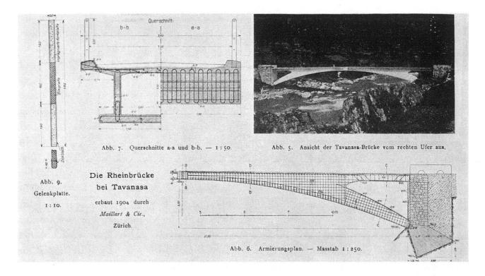
Abb. 9. Robert Maillarts Brücke bei Tavanasa über den Rhein (1904–05, 1927 vom Geschiebe weggerissen) wurde für den Eisenbetonbau wegweisend. Statisch und formal verschmolz er den Brückenbogen mit der Fahrbahn. Die schwungvolle Konstruktion erwies sich als besonders wirtschaftlich und preiswert. – Bildquelle: Schweizerische Bauzeitung, LXIII (1914), S. 344
