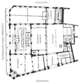
Abb. 9. Die Hauptpost nach dem Um- und Neubau durch Friedrich von Schmidt, 1878–1880 (Deutsche Bauzeitung, XVI [1882], S. 79)
