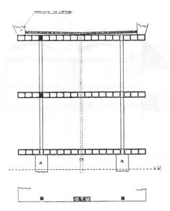
Abb. 5. «Domino»-System mit glatten Platten (entwickelt 1914)
