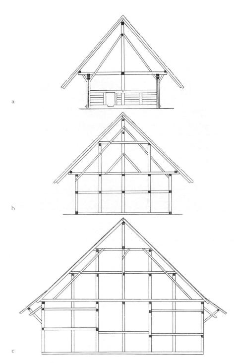
Abb. 7. Vergleichende Übersicht verschiedener Ständerkonstruktionen, Übergang zum Fachwerk.
