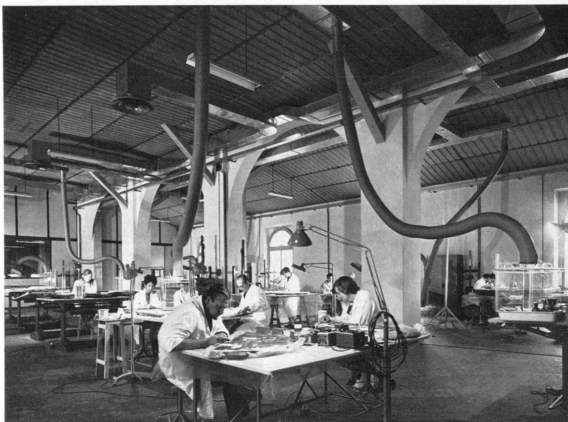
Eines der neueingerichteten Restaurierungsateliers in der Fortezza di Basso in Florenz. Deutlich sichtbar sind die Absaugvorrichtungen über jedem Arbeitsplatz; sie ermöglichen das Arbeiten mit den teilweise giftigen Lösemitteln
