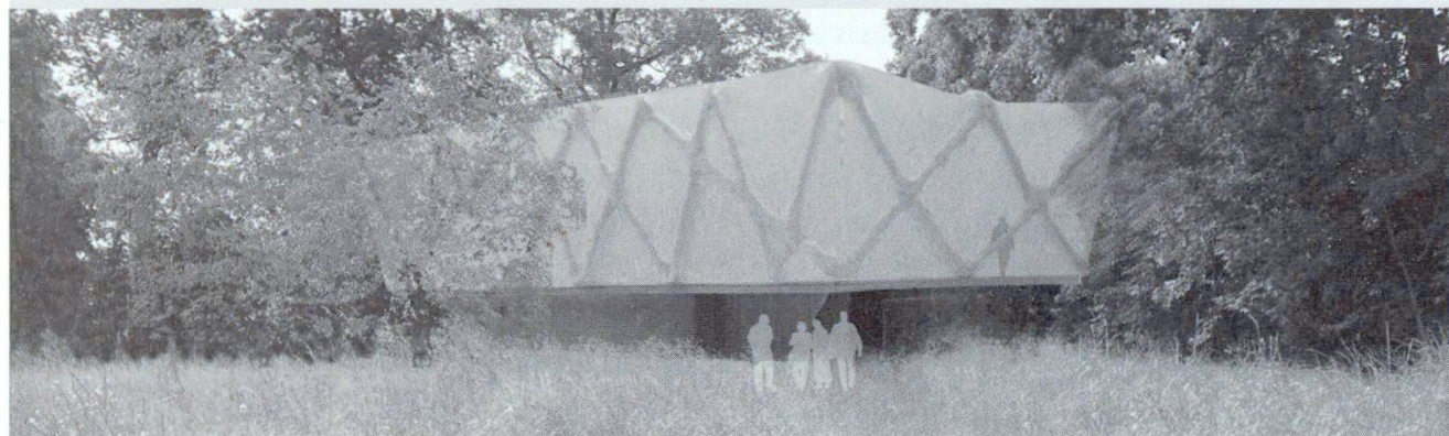
Marcel Hohl; Konstruktion PVC-Rohre mit Spritzbeton
