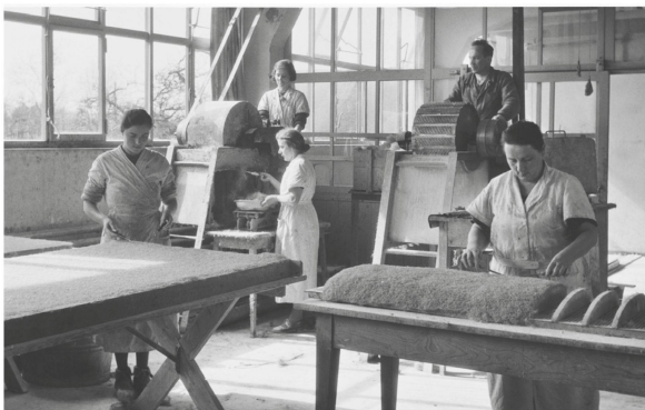
In der Formhaar-Produktion benetzen Quetschwalzen die Naturhaare mit flüssiger Gummimilch.
