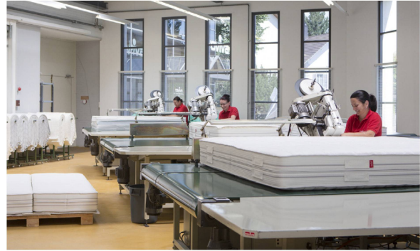
In der Schliesserei wird der Matratzenbezug über die Kerne gezogen und mit dem typischen Kederband zugenäht.
