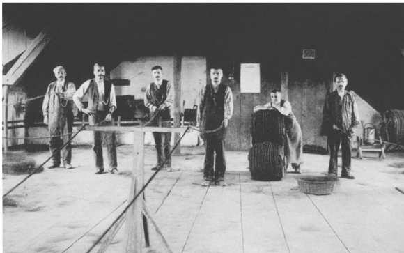
Rosshaar-Spinnerei nach alter Art, bereits mechanisch angetrieben um 1890.
