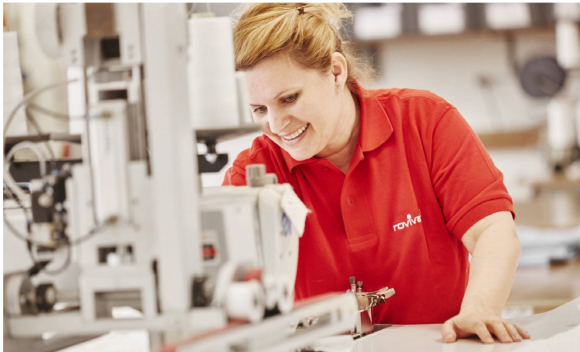
Der Reissverschluss wird in die Matratzenhülle eingenäht.
