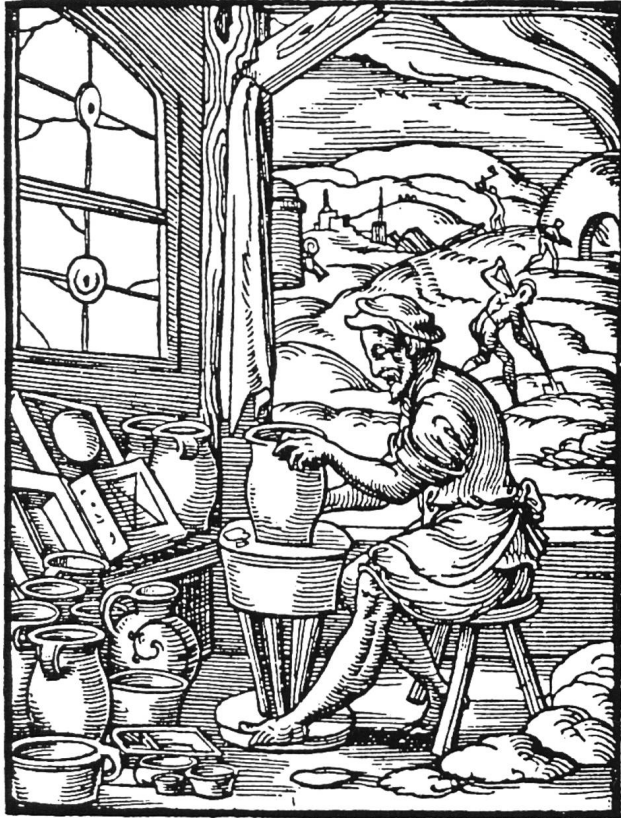
Hafner bei der Herstellung von Gefässen und Kacheln. Unter dem Fenster, links, sind Kachelmodelle erkennbar.
