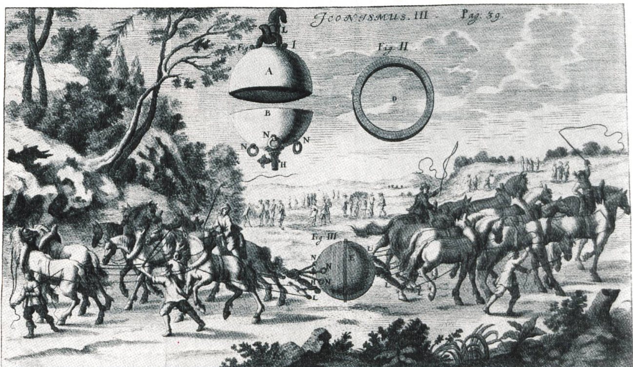
Kupferstich aus: Caspar Schott, Technica curiosa , Nürnberg 1664. Bibliothek des Deutschen Museums, München. Der Stich zeigt den bekannten Versuch mit den leergepumpten Halbkugeln, die selbst von 16 Pferden nicht auseinander gerissen werden konnten. O. von Guericke zeigte den Versuch zuerst 1658 in Magdeburg.
