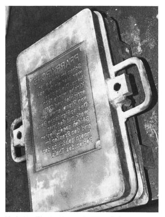
Nach dem Wenden des sandgefüllten Rahmens erscheint beim Abheben des Rahmenbodens mit dem Holzmodell der Negativdruck der Bronzetafel.
