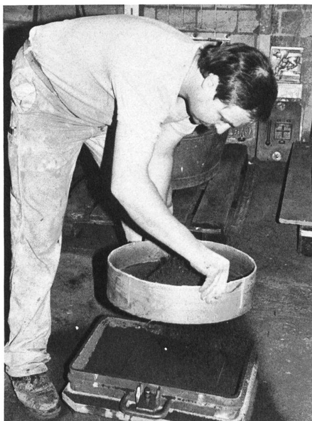
Der Giesser siebt den Formsand über das Holzmodell in den Rahmen.
