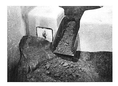
Das Pressen erfolgt durch das Niederschlagen eines Keiles. Durch die Hebebügel in der sich drehenden Welle wird der Hammer immer wieder angehoben und fällt auf den Keil. Durch das Abwärtsrücken des Keiles entsteht Druck auf den Ölbrei, und das Öl wird ausgepresst. Mit dem Gegenkeil wird die ganze Packung wieder gelöst.
