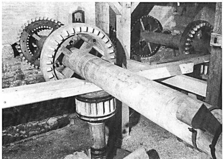
Die Reibe (Bild) und der Kollergang werden durch das jeweilige Kammrad an der Welle und den Drilling am Wendelbaum angetrieben. Der konisch gehauene Reibstein wird dadurch in Umdrehung versetzt und zerquetscht auf dem Mahltisch die Hanf- und Flachsstengel bzw. das Pressgut.
