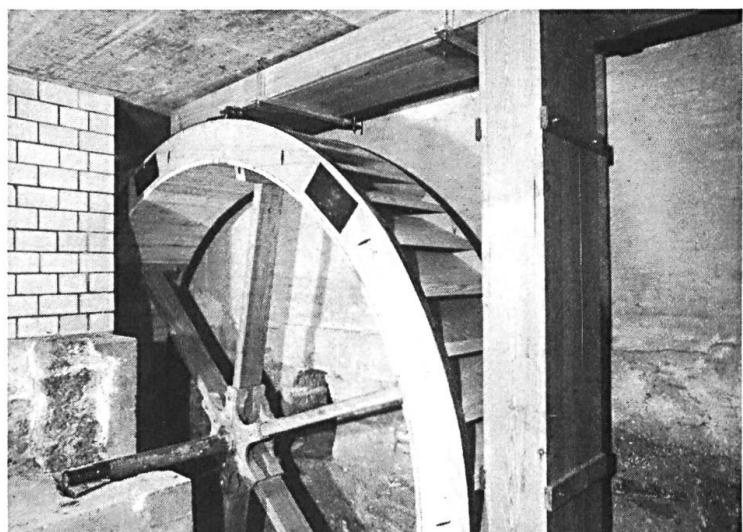
Das Wasser fliesst oben auf das Wasserrad (sog. oberschlächtiges Wasserrad) und treibt dieses durch die eigene Schwerkraft an. Dadurch können bereits mit dem relativ wenigen Wasser des Mülibaches grosse Kräfte entwickelt werden. Um die Umdrehung des Wasserrades zu steuern, ist vor dem Rad ein Sturzschacht mit einer Klappe vorhanden, so dass je nach Wasserführung ein Teil des Wassers abgezweigt werden kann.
