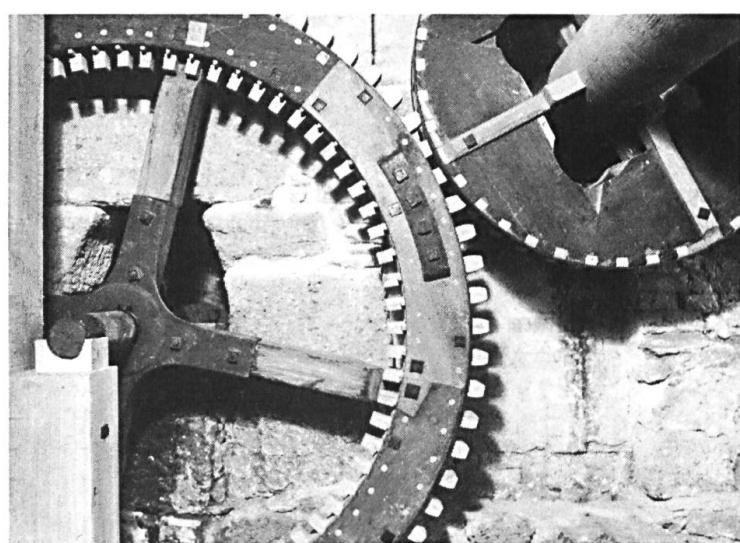
Die Achse des Wasserrades bringt die Energie auf das grosse hölzerne Kammrad im Ölraum, welches die Zahnräder an den einzelnen Wellen in Bewegung setzt. Für das Rührwerk des Ofens ist ein separates kleines Zahnrad montiert.
