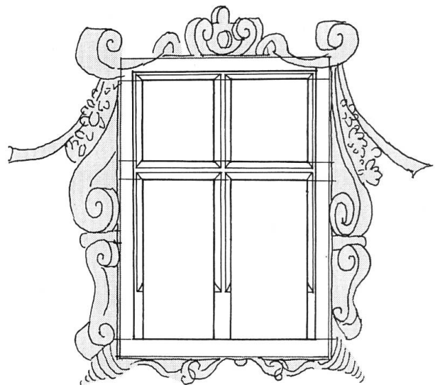
17 Das Fenster mit dem Kreuzstock im 2. Obergeschoss des ehemaligen Ostgiebels. 1:50. Befundaufnahme und Rekonstruktionsversuch.
