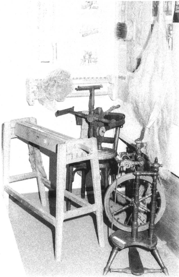
Hanfverarbeitung: Räsche, Hechel (oben an der Wand), Spinnrad mit Rocken und Hanf, Haspel.
