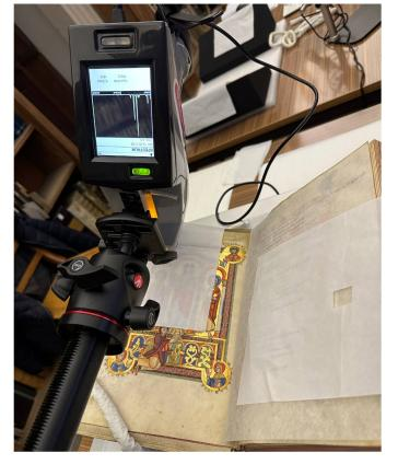
Zerstörungsfreie Analysen mittels Handheld XRF im Rahmen des Forschungsprojekts zu den heiligen Schriften in der Staatsbibliothek Bamberg.
