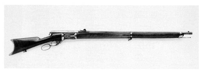
Abb. 57 Repetiergewehr. Unterhebelmechanismus mit Zylinderverschluss. Büchsenmacher: Gamma & Infanger. Altdorf. 1868. 132,5 cm.
