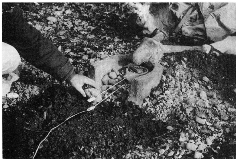
Abb. 7. Temperaturmessung im Schmelztiegel während des Gussvorganges.
