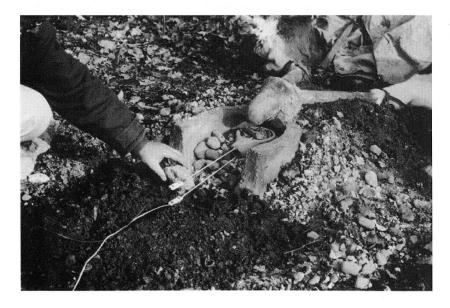
Abb. 7. Temperaturmessung im Schmelztigel während des Gussvorganges.
