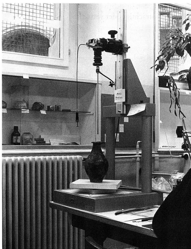
Abb. 1. Das auf eine Kleinbildkamera montierte Endoskop.
