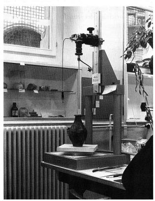
Abb. 1. Das auf eine Kleinbildkamera montierte Endoskop.
