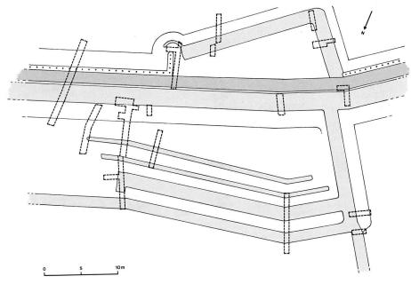
Fig. 4. Plan du castellum d'après Blondel (note 5, fig. 1). En gris soutenu, la levée de terre du murus; en gris clair, les fossés. La disposition des tranchées de Blondel (en traitillé) montre la part d'extrapolation dans ses conclusions. Dessin C. Geiser.
