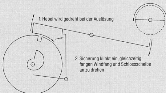
Fig. 11. Auslöse- und Stoppmechanismus, Stellung kurz nach Auslösung.
