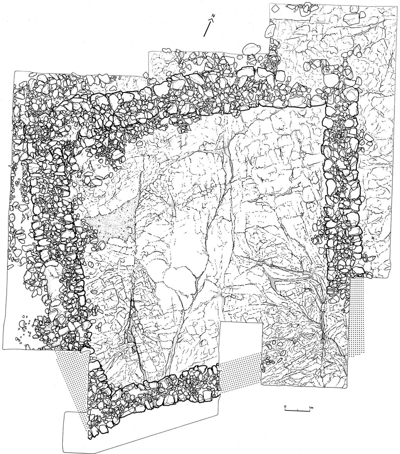
83. Ausgrabung in der Höhengiedlung Motta Vallac, Gemeinde Salouf (Kt. Graubünden). Grundriß eines Wehrturmes aus der Spätantike, mit mörtellos gefügtem Fundament und Holzaufbau (S. 44 und 73 ff.)
