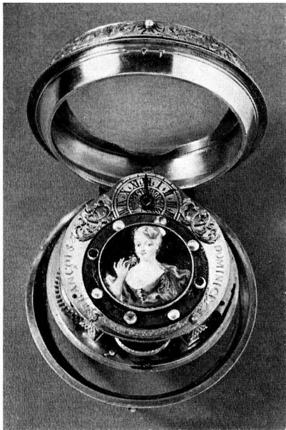
23./24. Silberne Taschenuhr mit beidseitigem Glasdeckel. Unruhe mit Emailmedaillon verdeckt. Arbeit von François Dominicé, Genf. Um 1700 (S. 57)
