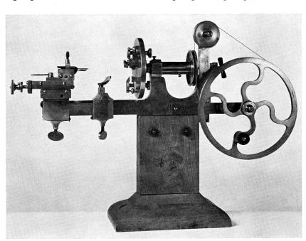
30. Handdrehbank für Kleinuhrmacher, aus La Chaux-de-Fonds. Um 1830. Höhe ca. 45 cm (S. 54)
