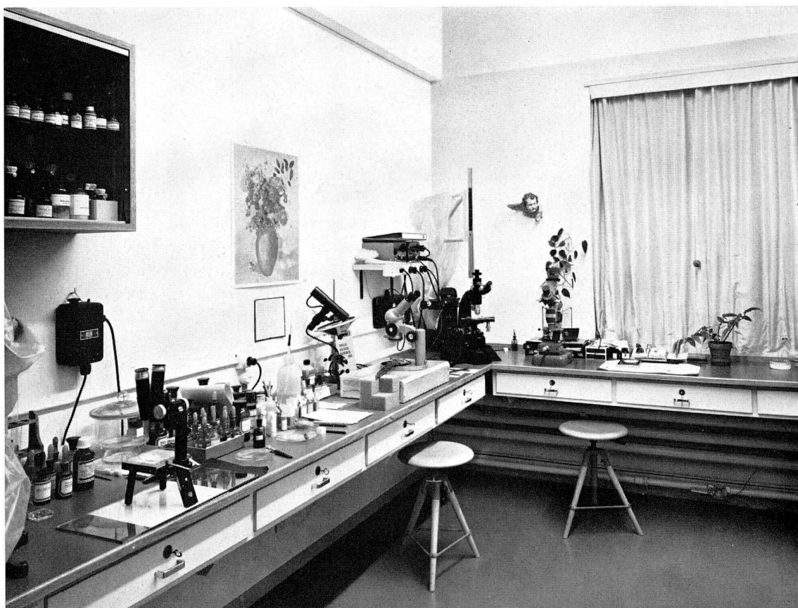
Bild 1. Mikroskopieraum; v. l. n. r. Binokularlupe f. halbmikrochem. Untersuchungen, Leuchtkasten mit Binokularmikroskop und monochromatischen Lichtquellen für Gewebeuntersuchungen. In der Ecke Universalmikroskop mit Leica- und Plattenkamera, sowie Mikrospektralphotometer (im Bilde nicht dargestellt). Rechts daneben Mikrohärtemessgerät.
