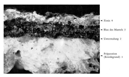
Bild 6. Madonna von Raron. Querschnitt durch die Fassung des Mantels.
