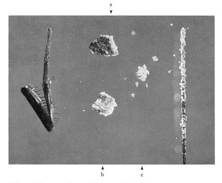
Bild 5. Madonna von Raron. Abgelöstes Teilchen der Fassung (a), wovon ein kleiner Splitter abgetrennt und für die Herstellung eines Querschnittes (Bild 6, unten) verwendet wurde. (b) zeigt dasselbe Teilchen nach der Abnahme des blauen Pigmentes (c), das schliesslich auf den dünnen Glasfaden (rechts aussen) aufgetragen wurde.
