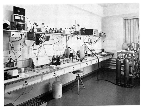
Bild 2. Labor für Spektralphotometrie; v.l.n.r. Papierelektrophorese für Farbstoff- und Bindemitteluntersuchungen; Leitfähigkeitsmessgerät z. Kontr. von Waschwässern und Konspräparate f. Holzkonservierung und Metallkoservierung; pH-Messgeräte; darüber Quarzlampen. Freistehend: Absorptionsspektralanalyse.
