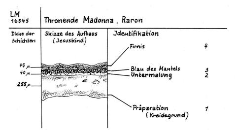
Bild 7. Legende zu Bild 6 zeigt den prinzipiellen Aufbau der Fassung. Solche Skizzen werden für jeden Querschnitt angefertigt. In Ergänzung zur Photographie (Bild 6), die mit allen Zufälligkeiten des gewählten Präparates belastet ist, soll die Zeichnung nur das Wesentliche des Aufbaus und das Eigentümliche einer bestimmten Fassung herausheben.
