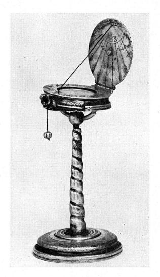
Abb. 8a. Sonnenuhr, messingversilbert, auf späterem Fuss, von einem Zuger Goldschmied Wikart, dat. 1567. (S. 25)
