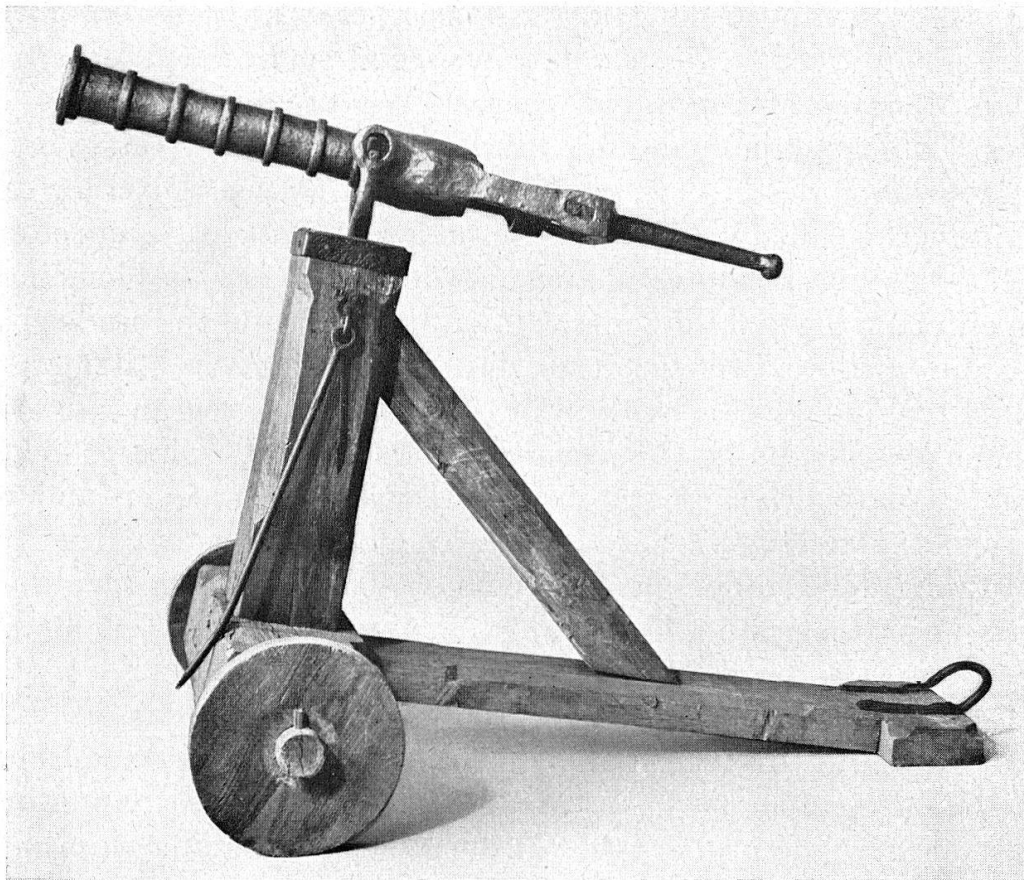
Abb. 5 Mauergeschütz mit schmiedeeisernem Hinterladerrohr. Auf rekonstruierter Lafette, aus Bregenz (?), 15. Jh. (S. 38)
