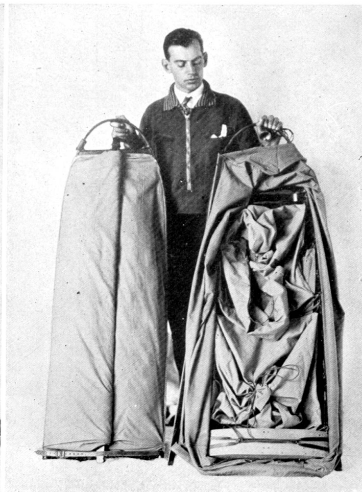
Cette photo montre la bâche qui permet de protéger hermétiquement le contenu de la „poulka“ en cas de tourmente de neige
