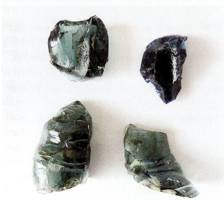
Abbildung 14: Pfeifenabschläge, oben sind die Negativabdrücke der Glasmacherpfeifen gut erkennbar – Schafmatt I, untere Hütte.
