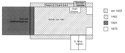
Abb.2: (mef) Schematisierter Grundriss-Plan der verschiedenen Bauphasen der alten Oltner Stadtkirche.
