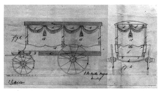
Abb. 7: Ausschnitt aus dem der Offerte für den Totenwagen beiliegenden Plan. Der Wagen war zur gleichzeitigen Beförderung von zwei Särgen eingerichtet. (StAO, GA 18.09.02.08)
