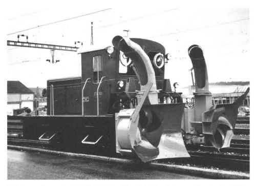
[22] Anwendungsmöglichkeit für Hydro-Titan-Getriebe: Schneeschleuder der SBB.
