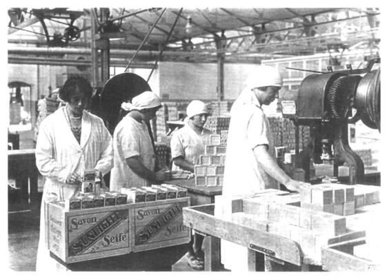
Abb. 12 Stempelsaal Seifenfabrik Helvetia 1930. Fotoalbum, A 268. 1908 verzeichnete die Plant Valuation eine handbetriebene Stempelmaschine, die das Stempeln von 600 Seifen pro Stunde erlaubte und zwei Rotationsmaschinen, die je 1500 Seifen pro Stunde stempelten. 1917 kam eine automatische Stempelmaschine mit einer Leistung von 2700 Seifen pro Stunde dazu. Die aus Port Sunlight übernommene Schneidemaschine zerlegte 1.2 Tonnen Seife pro Stunde. StAO FA HVS 02. A 246. Plant Valuation.
