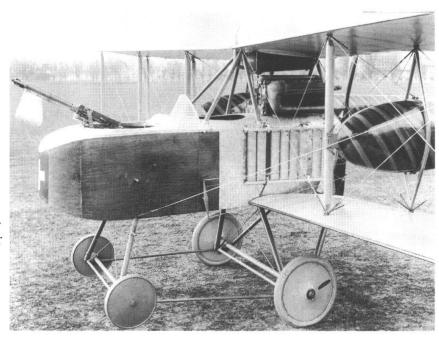
Abb. 4: DH-1. Zuvorderst sass der Beobachter mit dem Maschinengewehr, dahinter war der Pilot, anschliessend kamen der Motor und der Propeller.
