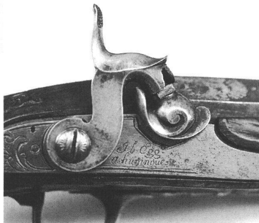
Abb. 18: Schlossplatte einer Stein- schlosspistole, die von Hans Jakob Egg, Hünningen, in eine Perkussionspistole umgewandelt wurde, nach dem System seines Sohnes Joseph Egg London. Der Lauf ist goldtauschiert, der Kolben geschnitzt und mit Silbereinlagen ver- sehen. (Kantonales Museum Altes Zeughaus Solothurn)
