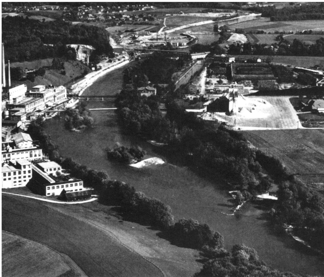
Abb. 84: Die Abbildung (75. Jahresbericht AEK, 1969, 13) zeigt den Verlauf der Aare und des Aare-Emmenkanals zwischen den Anlagen der Cellulosefabrik Attisholz. Vorne rechts Kanaleinlauf, am Kanalende Zentrale und Unterwerk Luterbach, dahinter die Baustelle des Kraftwerkes Flumenthal der ATEL. (Foto nach 1966, vor 1969). Die Abbildung illustriert die von uns anhand der topographischen Karten geschilderten Verhältnisse plastisch.
