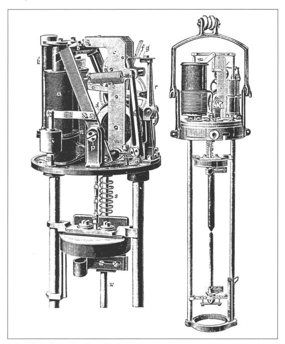
Abb. 105: Aufbau einer Bogenlampe.
