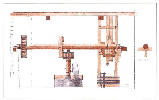
Abb. 1: Ansicht der Ölpresswelle mit Kollergang und Öltrotte.
