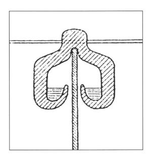
*Abb. 68:* Abbildung eines Flüssigkeitsisolators (Weber 1887, 336).
