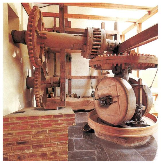
Abb. 2: Ölmühle aus Lohrhaupten, Spessart um 1750 (O). Fette gehören neben Eiweiss und Kohlenhydraten zu den drei Grundnahrungsmitteln. Fette und selbstverständlich auch Öle waren deshalb jahrhundertelang etwas Begehrenswertes und Kostbares. In dieser von einem Wasserrad angetriebenen Mühle verarbeitete man Ölfrüchte, wie etwa Raps, Mohn, Lein (Flachs), Hanf und Sonnenblumen, ferner Nüsse und Bucheckern. Die Ausbeute von einem Zentner Raps betrug beispielsweise 24 Liter Öl.
