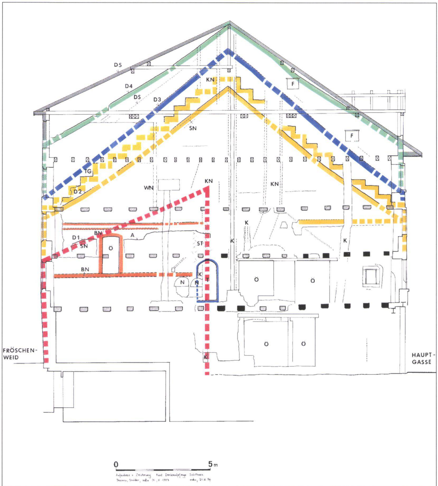
Abb. 5: Querschnitt, Blick nach Osten an die Brandmauer mit allen beobachteten bauhistorischen Spuren.
