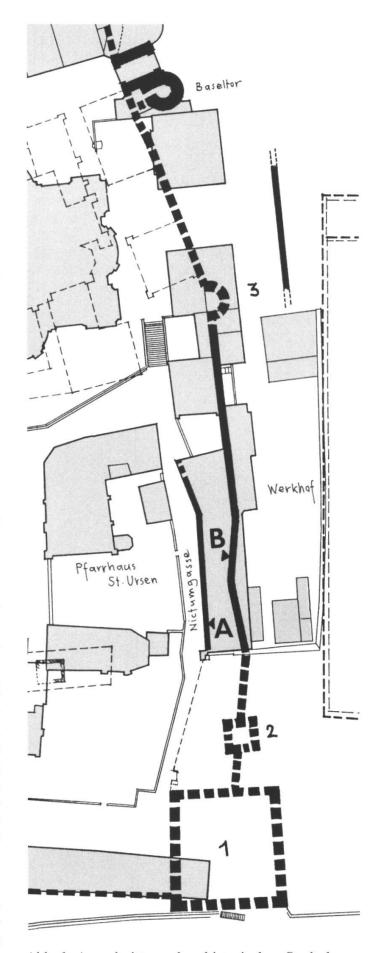
Abb. 1: Ausschnitt aus dem historischen Stadtplan. Ausgezogene schwarze Linien = erhaltene Reste der vorbarocken Stadtmauern, unterbrochene schwarze Linien = abgebrochene vorbarocke Stadtmauern. A innere Mauer, B äussere Mauer. 1 Bollwerk zum Ritter, 2. St. Petersturm, 3 offener Halbrundturm.
