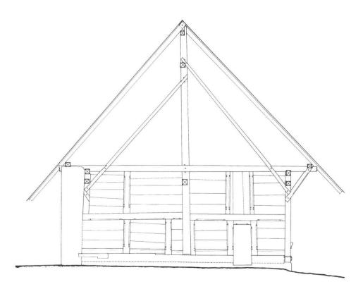
Abb. 4: Querschnittaufnahme durch das Tenn, 1981.
