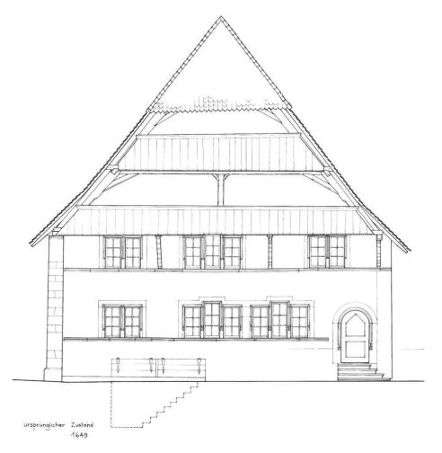
Abb. 2: ... und nachher (Ideal-rekonstruktion nach Befund).
