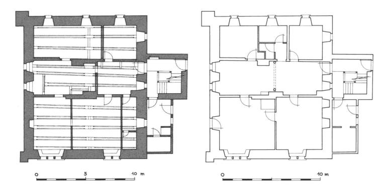
*Abb. 7a:* Grundriss Erdgeschoss mit eingezeichneter Deckenbalkenlage. Aufnahme 1991.
