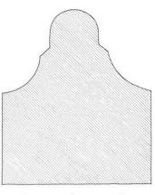
*Abb. 2:* Bruchstücke von Fenstergewänden aus Sandstein, aus der Zeit um 1550. Seitenansicht und Profil.
