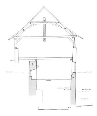
Abb. 6: Ansicht innere Stadtmauer (grau gerastert) mit aufgebautem jüngerem Magazin (weiss). Unten Grundrissaufnahme der beiden Stadtmauern.
