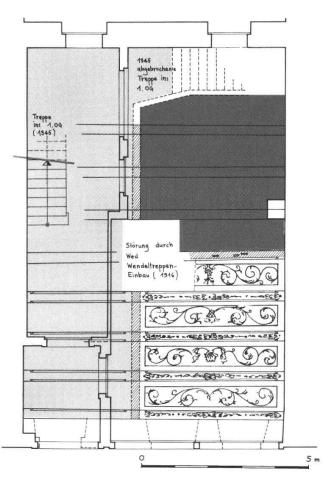
Abb. 1: Grundriss Erdgeschoss mit eingezeichneter Balkendecke. Schematisch dargestellt die bemalte Decke im gassenseitigen Raum, deunkelgrau gerastert der Bereich der ehemaligen Küche, hellgrau der Korridor.
