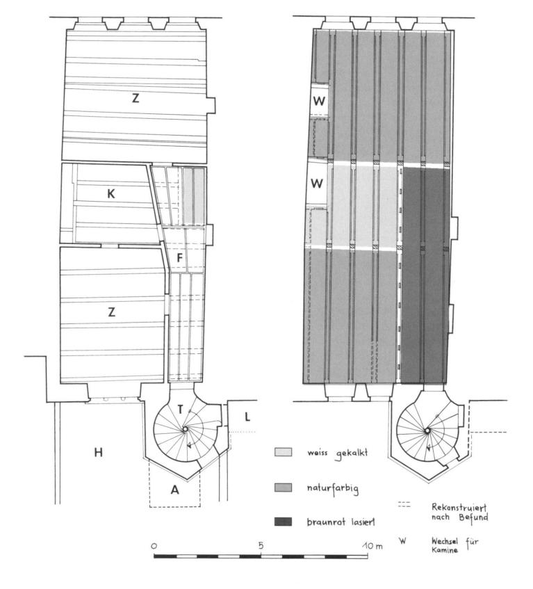
*Abb. 6:* Grundrissplan zweites Obergeschoss im Zustand von 1990, vor dem Umbau.
