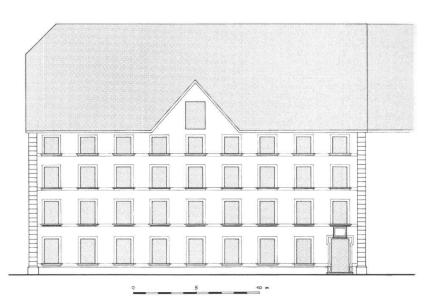
Abb. 5: Südfassade, Bereich Osttrakt, Rekonstruktionsversuch Zustand 1740-1785.
