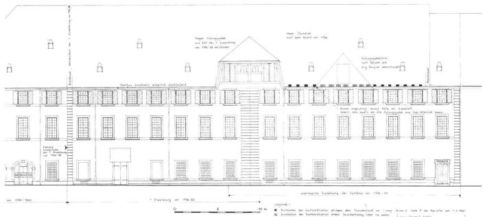
Abb. 3: Südfassade, Befundaufnahmeplan (Ausschnitt).
