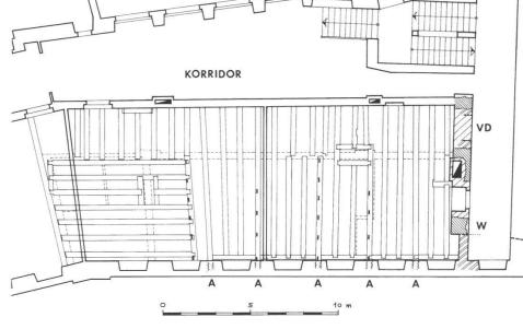
Abb. 12: Bettensaal Ost, Wandansicht Süd mit Negativen früherer Wände (W), und Böden (B).
