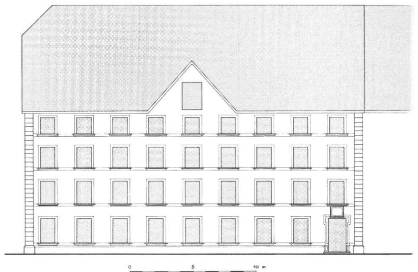
Abb. 5: Südfassade, Bereich Ostrakt, Rekonstruktionsversuch Zustand 1740–1785.
