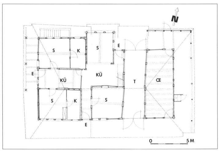
Abb. 5: Grundriss Erdgeschoss. Die Signaturen bedeuten: S = Stube, K = Kammer,  $K\ddot{U} = K\ddot{u}che$ , E = Eingangstüren von aussen, <math>T = Tenne,  $OE = \ddot{O}konomieteil$ . Fein gestrichelt = Deckenunterzüge bzw. Balkenlagen, gröber gestrichelt = Trauflinien, Gräte und First des Daches.
