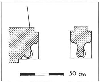
Abb. 10b: Profilformen der Sandsteinfenstergewände aus dem 16. Jahrhundert.
