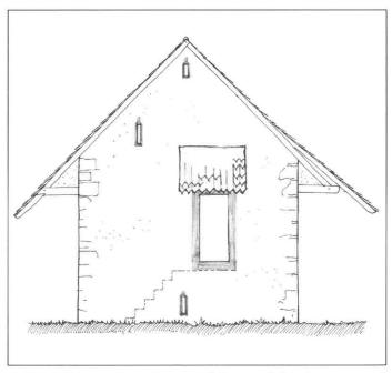
Abb. 7: Südansicht des «Gerichtsstöcklis» im Zustand von 1564. Rekonstruktionsskizze nach Befunden am Bau (vgl. auch den heutigen Zustand, Abb. 11).
