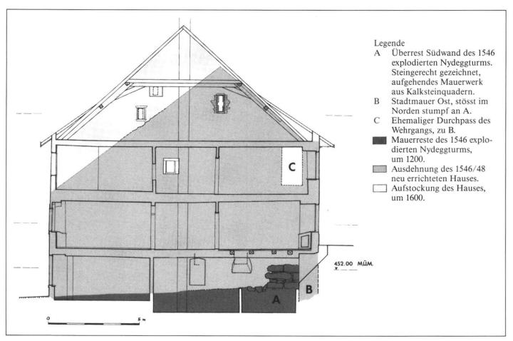
Abb. 13: Riedholzplatz Nr. 32, Querschnitt durch den Wohnteil, Blick nach Norden an die Innenseite des Giebels, der die Häuserzeile bis etwa 1670 im Norden abschloss.
