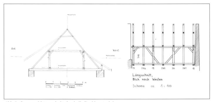
Abb. 2: Quer- und Längsschnitt durch die Dachkonstruktion.
