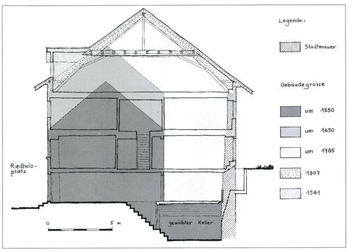
Abb. 6: Schematischer Querschnitt durch das Haus Riedholzplatz Nr. 30, Bauphasenplan.
