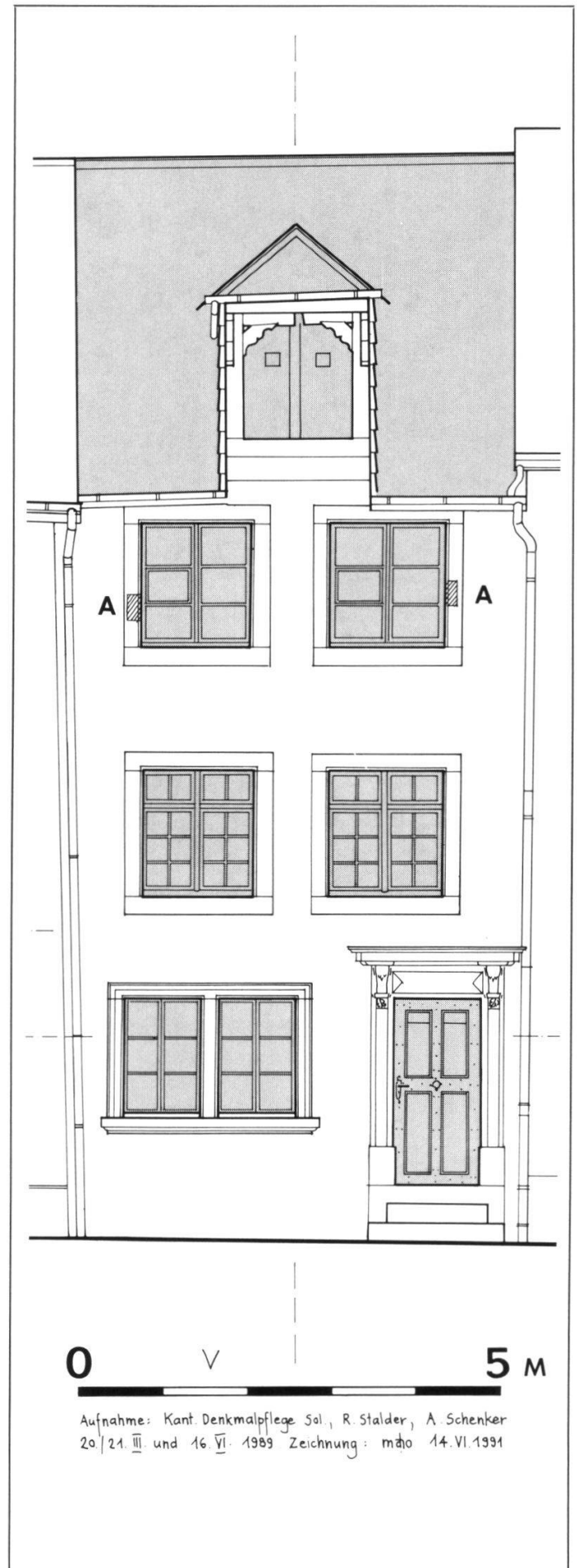
Abb. 1: Fassade Rathausgasse 6, Handaufnahme 1989, vor der Renovation. A = Ausnehmungen, Auflager der ehemaligen Stützbüge zu einem Vorgängergiebel.
