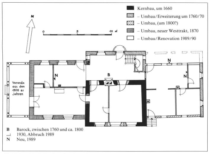
Abb. 12: Grundriss Erdgeschoss, Bauphasenplan.
