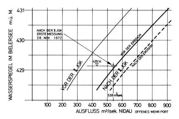
Abb. 15: Die Steigerung des Abflussvermögens aus dem Bielersee bei Hochwasser. Offenes Wehr Port. (Aus: Robert Müller, 1974, «Die Korrektion des Nidau-Büren-Kanals»)
