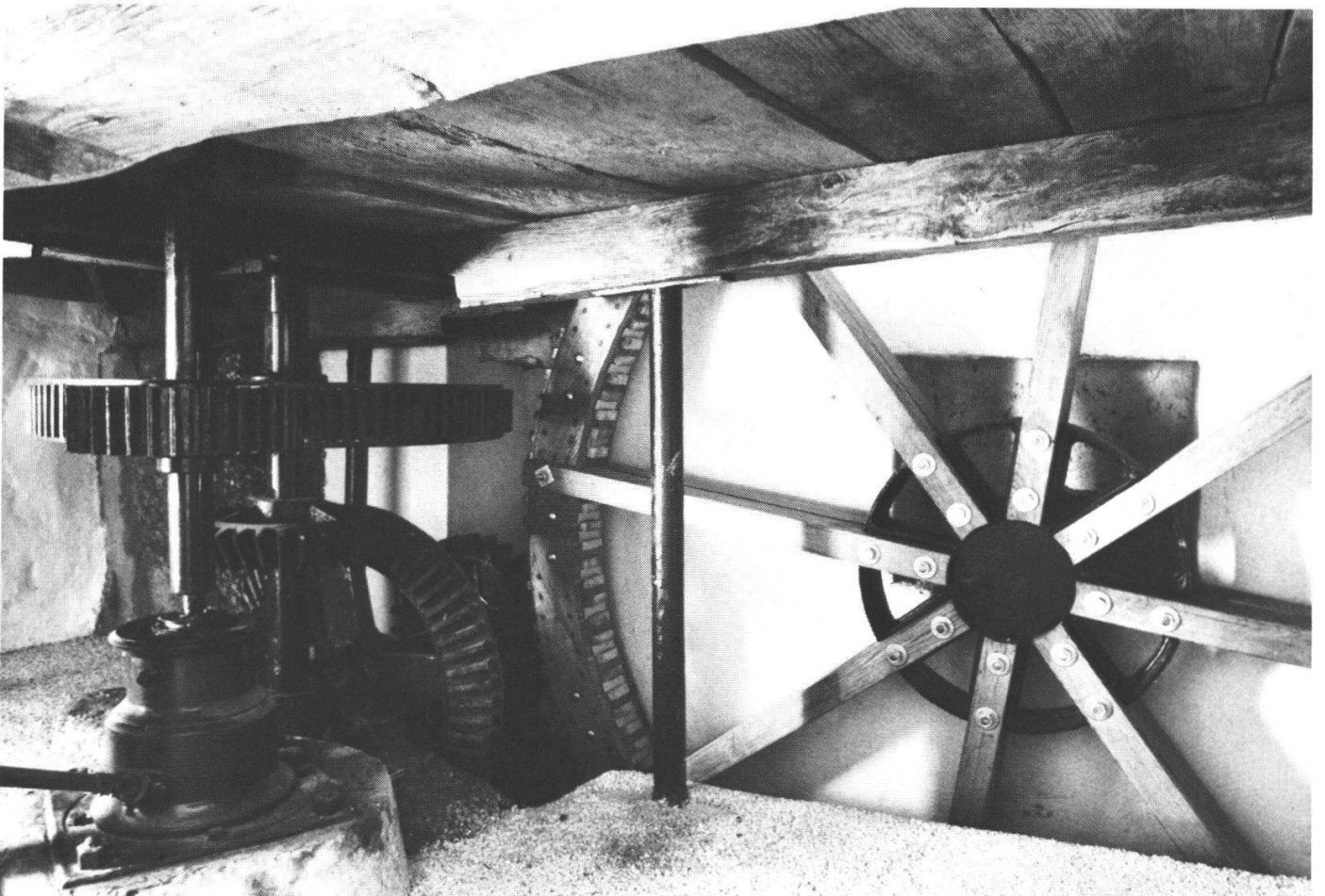
Abb. 4: Raderwerk unter dem Mahlstuhl: rechts das holzerne Kammrad, links die gusseisernen Zahnrader.
