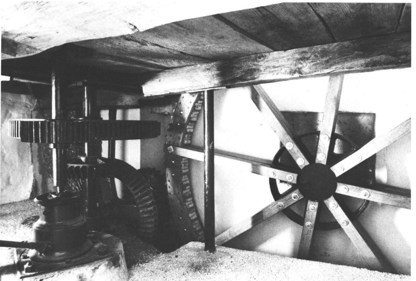
Abb. 4: Räderwerk unter dem Mahlstuhl: rechts das hölzerne Kammrad, links die gusseisernen Zahnräder.
