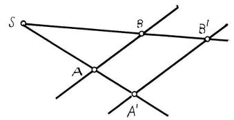
Proportion:  $\overline{AB}$ :  $\overline{A'B'}$  =  $\overline{SA}$ :  $\overline{S'A'}$  =  $\overline{SB}$ :  $\overline{S'B'}$
