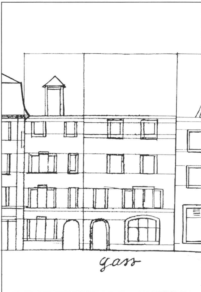
Abb. k: Ansicht der beiden Häuser Gerberngasse 1 und 3 um 1826/27 (J. B. Altermatt). Die unregelmäßige Befensterung weist auf verschiedene Bauphasen hin.
