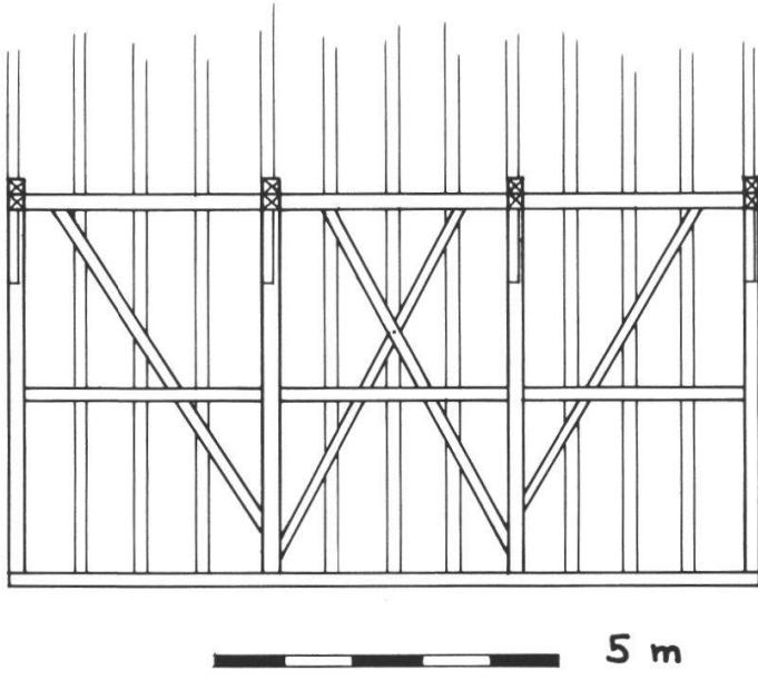
Abb.f: System der Windverstrebungen, schematische Innenansicht an die Dachfläche Nord.
