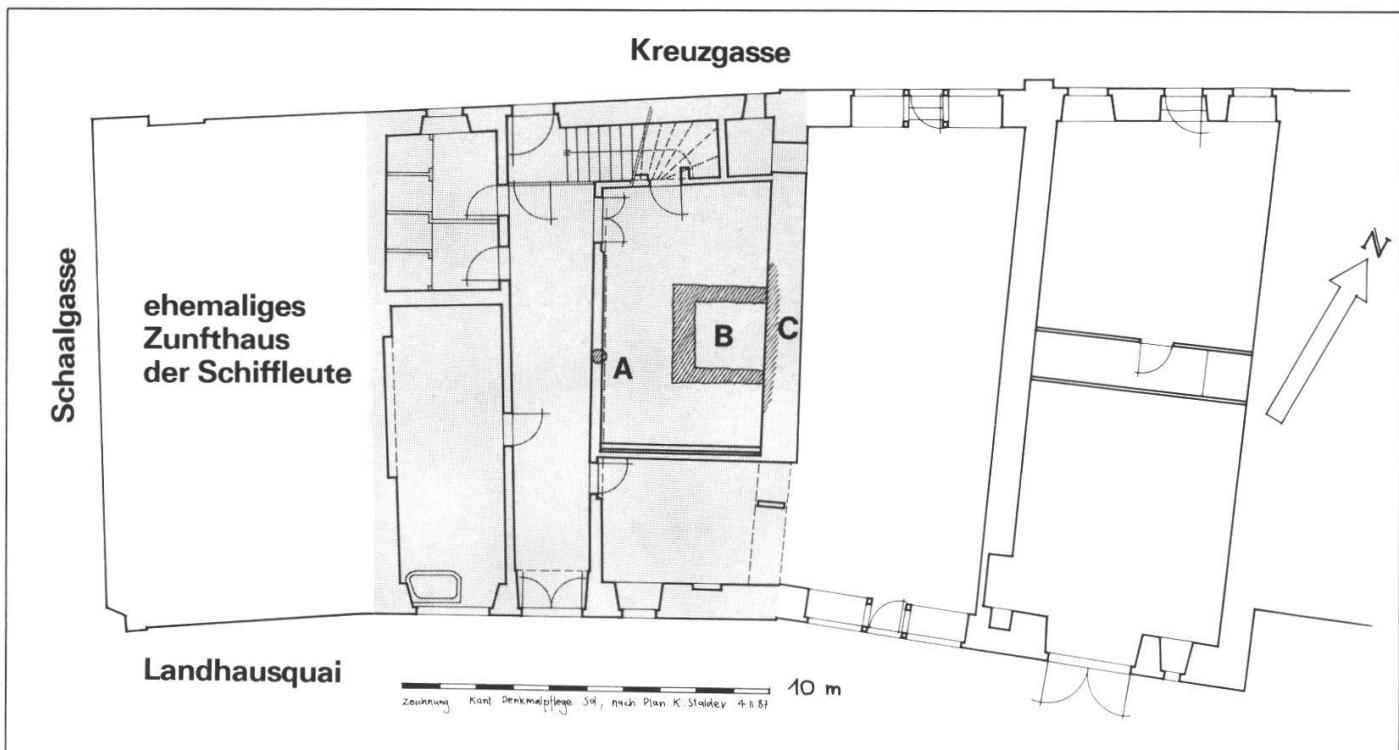
Abb. a: Restaurant «Kreuz», Grundrissplan Erdgeschoss, Zustand 1987. Grau gerastert der Kernbau aus dem 15. Jahrhundert. A Lage des Eichenstudes, B Fundament ehemaliger Herd, C Mauerwerk aus grossen Steinquadern.
