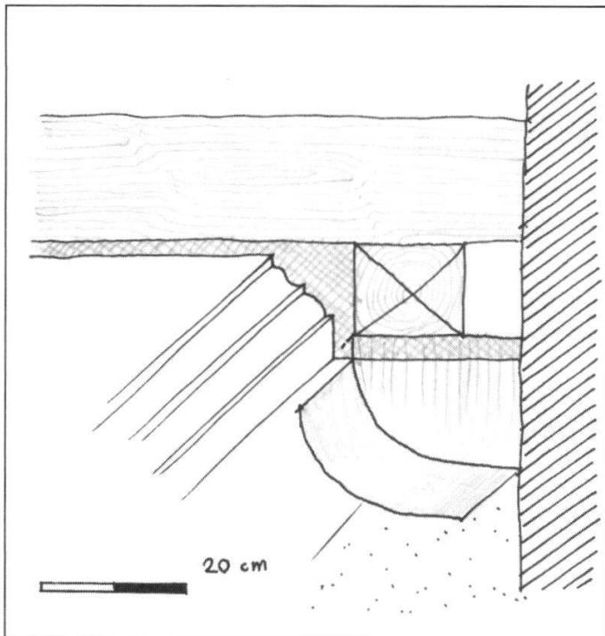
Abb. i: Übergangsprofil Anschluss Wand/Decke Vorderhaus 2. OG. Korridor.
