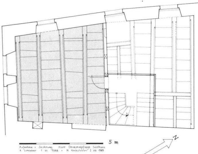
Abb. a: Solothurn, Friedhofplatz 22, Grundriss 1. Obergeschoss mit darüber liegender Balkendecke, grau gerastert, ehemalige Stube mit tapezierter Decke.
