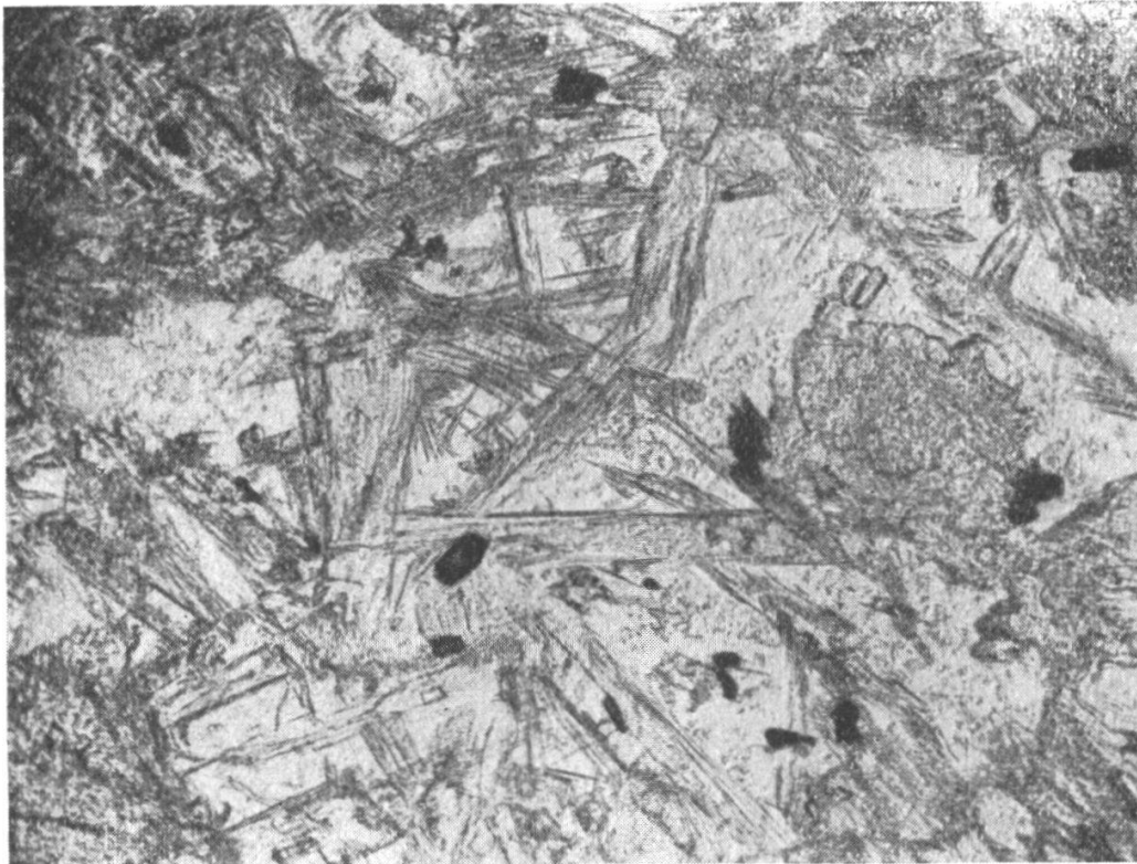
Fig. 1. Innig miteinander verwachsene, feinfasrige Mineralien eines Eklogit-Steinbeils. Burgäschisee Ost. Dünnschliffphoto, Vergrößerung 65-fach.
