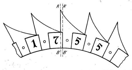
Abb. 16. Teilstück vom Steigrad des Gehwerkes. (Maßstab 1:2). Schnitte A-B und A'-B' siehe Abb. 17.
