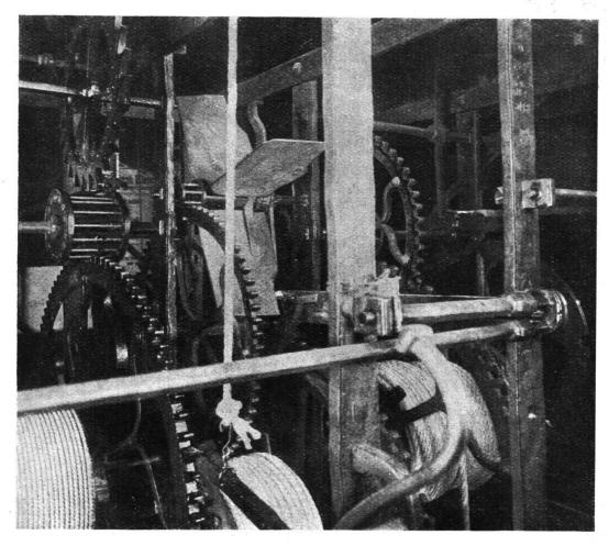
Abb. 30. Einzelne Anrichtungsteile des Viertelstunden- und Stundenschlagwerkes. Im obern Teile des rechten Eisenträgers des Uhrgestells sind noch die Meistersignaturen der Abb. 11 zu erkennen.
