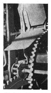
Abb. 29. Anrichtungsteile des Viertelschlagwerkes.
