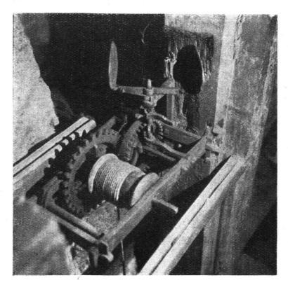
Abb. 36. Mechanismus für die Drehung des Stundenglases (Sanduhr).
