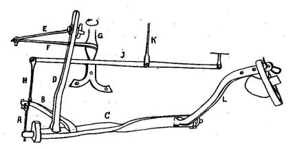
Abb. 8. Das Hebelwerk des Glockenschlägers.
