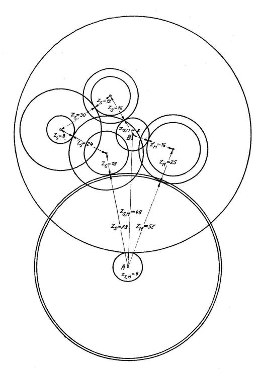
Abb. 40. Übersicht über die Anordnung der Räder des astronomischen Zeigerwerkes. (Maßstab 1:2.)
