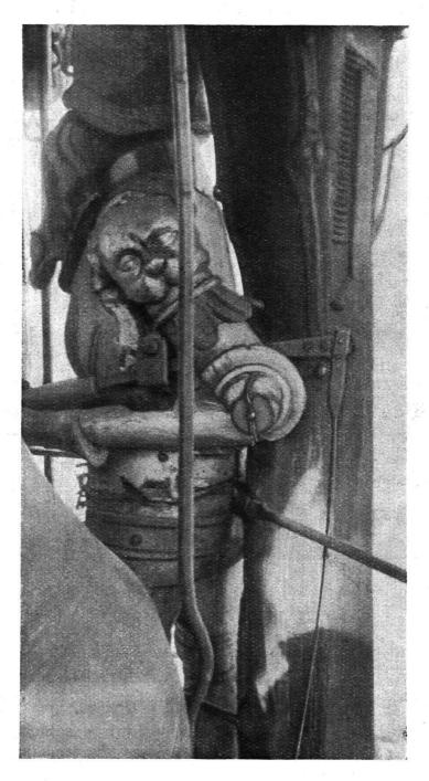
Abb. 5. Der Zugdraht führt zum Hebel, an dem der Schlaghammer befestigt ist.
