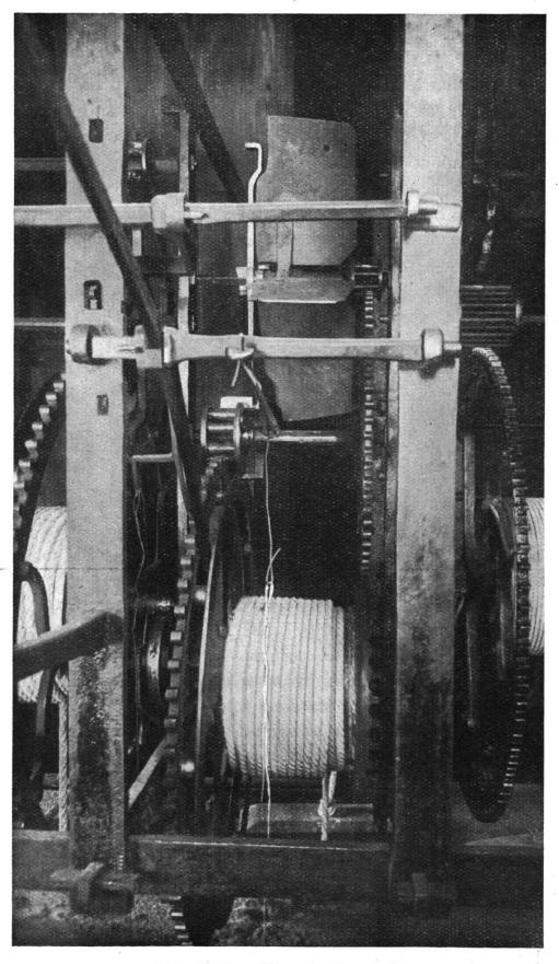
Abb. 27. Das Viertelschlagwerk.
