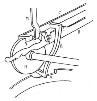
Abb. 28. Anrichtung des Viertelschlagswerkes mit Schlußscheibe und Falle. Vergl. auch Abb. 29.
